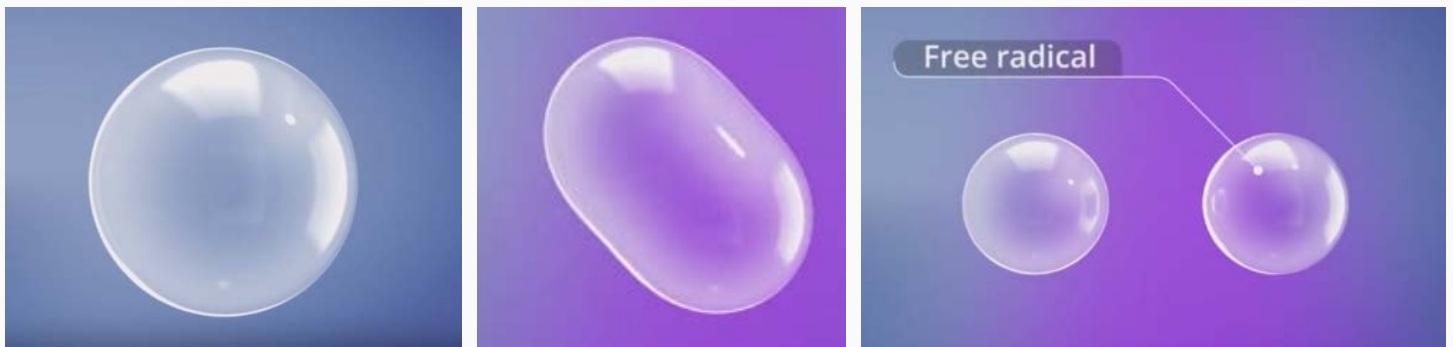
Figura 4: Os iniciadores, quando expostos à luz UV, dividem-se em radicais livres. Isto inicia o processo de polimerização e a reação em cadeia que liga monômeros e oligômeros em polímeros.
