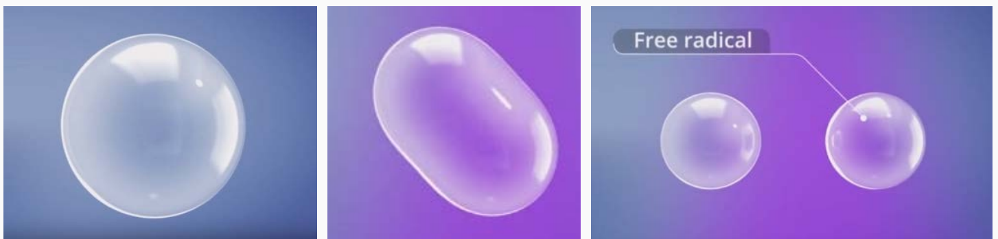
Figura 4: Los iniciadores, cuando se exponen a la luz ultravioleta, se dividen en radicales libres. Esto inicia el proceso de polimerización y la reacción en cadena que une monómeros y oligómeros en polímeros.
